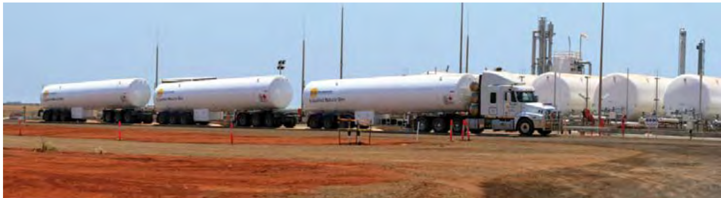
LNG Triple Road Train
